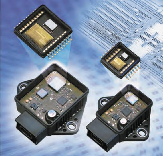
Actualmente, tanto Bosch como Teves ITT están montando en sus Sistemas de Control de Estabilidad, un sensor que agrupa en un sólo componente el de aceleración transversal y el de magnitud de viraje. Con esto se consiguen varias ventajas:
