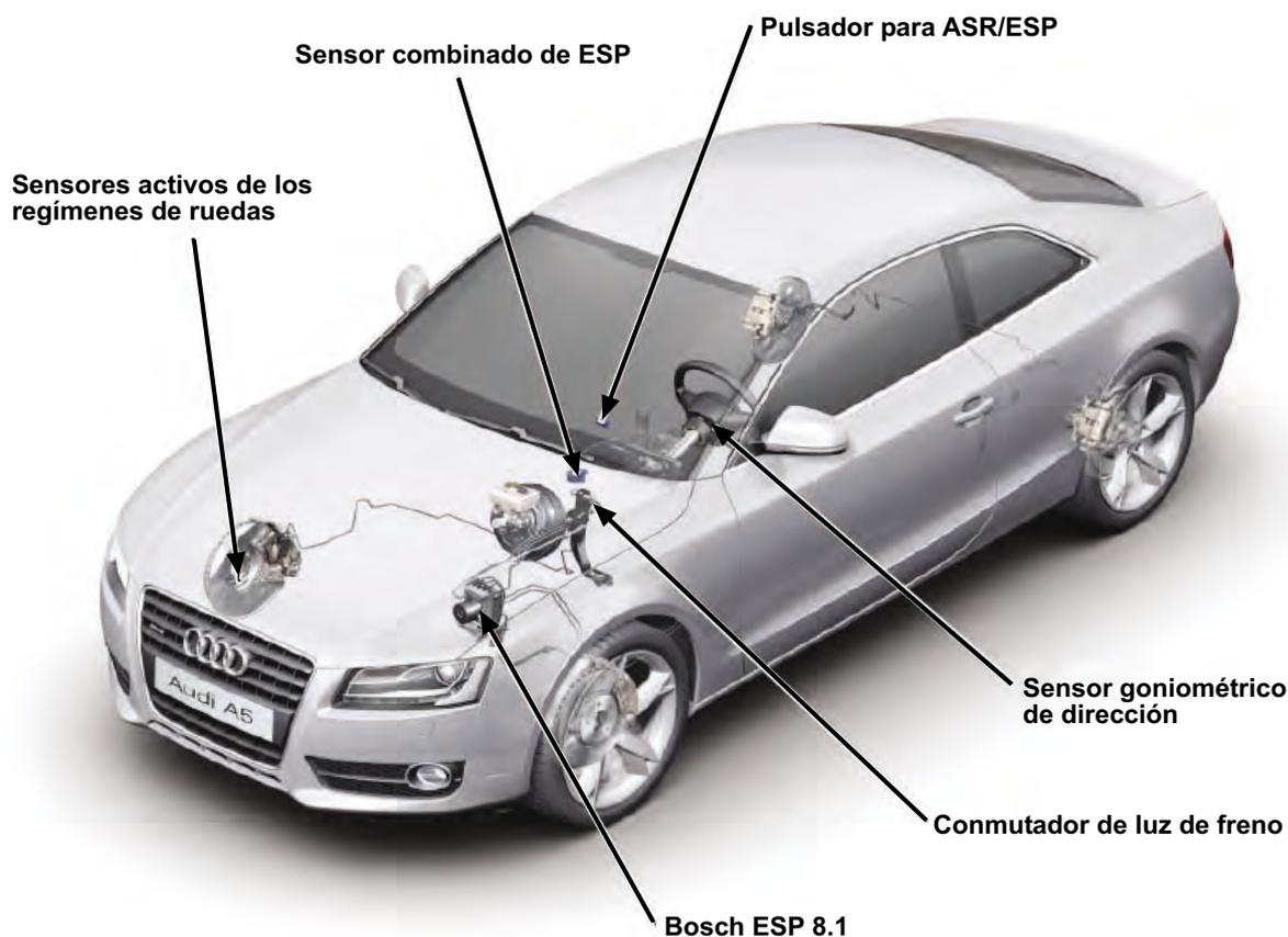
El ESP Bosch 8.1 dispone de válvulas de mayor capacidad y funciones implementadas respecto al ESP 8.0. Los sensores de ruedas son activos, es decir, envían una señal digitalizada hacia la Unidad de Control Electrónico.
