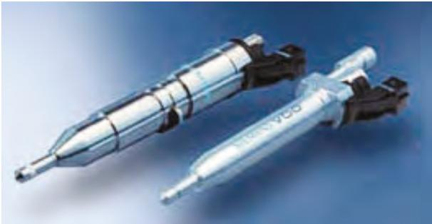
La mayoría de los equipos de inyección directa actuales utilizan inyectores electromagnéticos dotados de una bobina que al ser excitada desplaza un núcleo magnético que a su vez libera la aguja del inyector. No obstante Siemens ya tiene desarrollados unos inyectores piezoeléctricos listos para montar en sus equipos. Aventajan a los electromagnéticos sobre todo en la rapidez de accionamiento.
