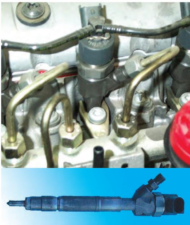
Los inyectores se montan directamente en la culata y se fijan mediante una brida.
