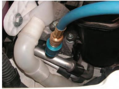
**Conectar las mangueras de alta y baja con todas las válvulas cerradas**
