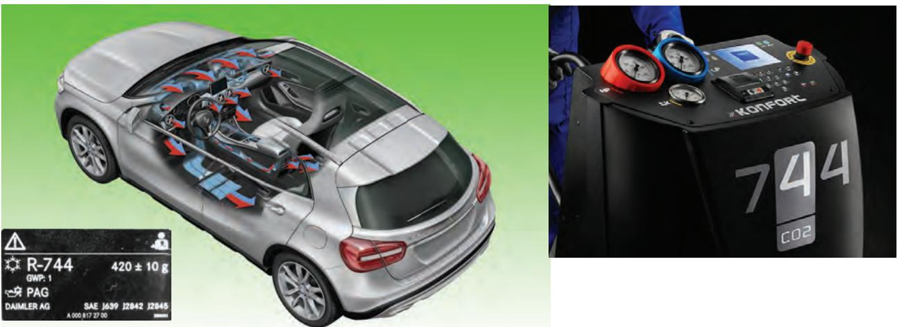
Cada vehículo debe disponer de una etiqueta identificativa del gas refrigerante que incorpora, la capacidad del circuito en gramos, el tipo de aceite necesario y las instrucciones de seguridad. Es imprescindible respetar las indicaciones de la etiqueta identificativa. Para cada tipo de gas, se necesita una máquina específica. No son compatibles ni las máquinas ni los aceites. Es imperativo utilizar el agente refrigerante y el aceite específico de cada sistema de climatización.
