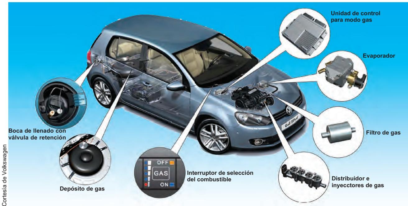
Los componentes adicionales necesarios para el funcionamiento con gas GLP son los siguientes:
