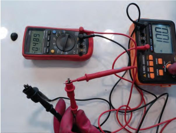
Antes de realizar la prueba de aislamiento, hay que verificar el funcionamiento del megaóhmetro tal como se indica en la página 40 de este manual. El circuito de alta tensión ha de estar desconectado. El megaóhmetro ha de indicar la impedancia de entrada del voltímetro (10 MΩ) y el voltímetro la tensión insuflada por el medidor de aislamiento (aproximadamente 500 voltios).
