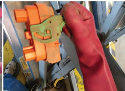
Para retirar la tapa de protección, hay que deslizar un seguro que libera las pestañas de sujeción de la tapa y estirar de ésta.
